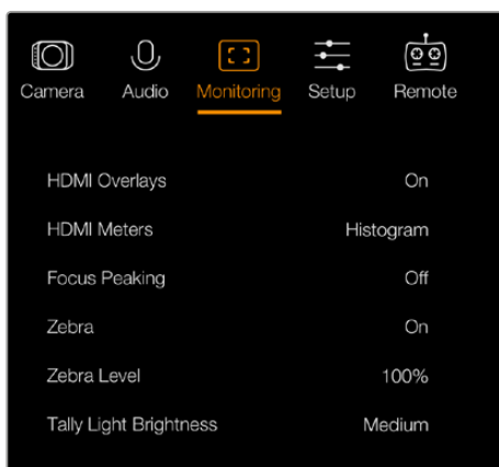
Impostazioni di monitoraggio di Blackmagic Micro Studio Camera 4K
