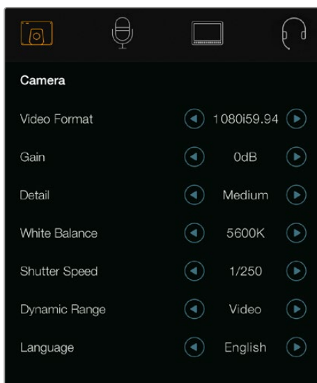
Настройки Camera на Blackmagic Studio Camera
