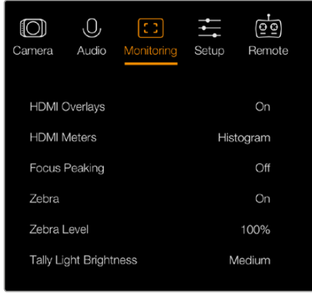
Monitoring settings (Görüntüleme ayarları) - Blackmagic Micro Studio Camera 4K.
