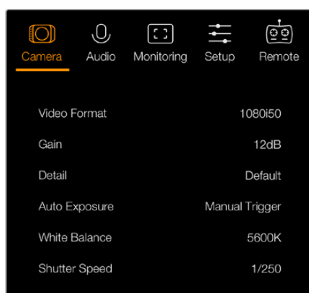
Impostazioni Camera di Micro Studio Camera 4K
