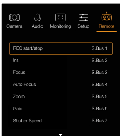
Configurações de Controle Remoto - Blackmagic Micro Studio Camera 4K.
